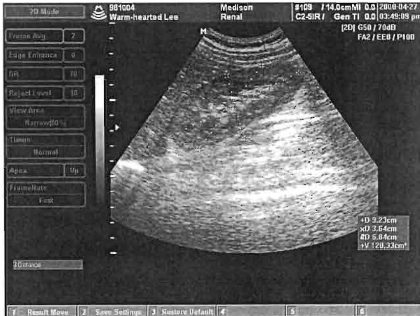
[Fig. 15.5 Misurazione del volume con 3 distanze]
